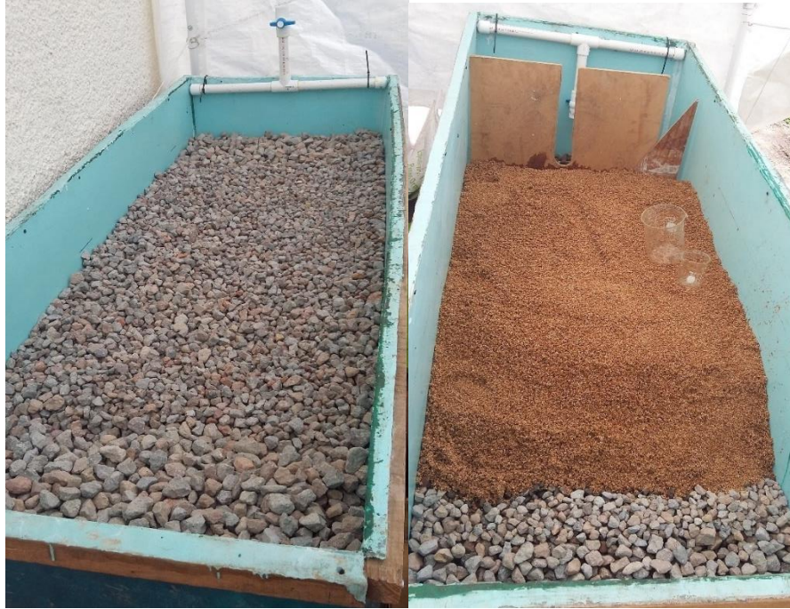
Figura 5. Humedales artificiales con los medios porosos. a) HA-FHSS con medio poroso simple: grava, b) HA-FHSS con medio poroso mixto: grava y vermiculita.
