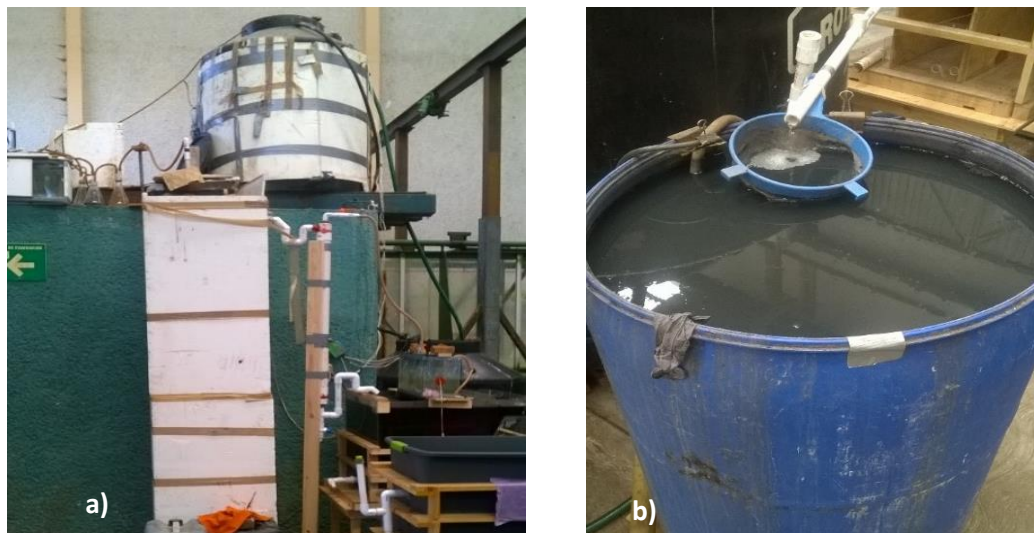
Figura 8. a) Reactor Anaerobio de Flujo Ascendente (RAFA) y sedimentador de lamelas. b) Efluente del sedimentador de lamelas, efluente utilizado en los HA-FHSS.
